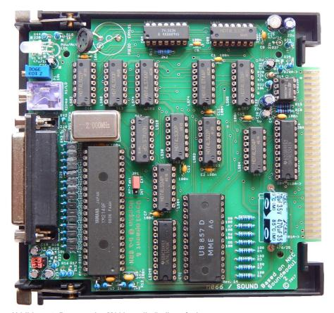
Abbildung 4: Prototyp des M066 – vollständig aufgebaut
