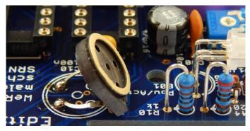
Abbildung 8: Einbau des Minilautsprechers
